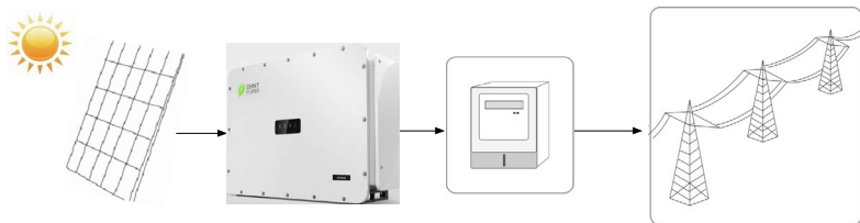
Figura 2-1 Sistema fotovoltaico ligado à rede
