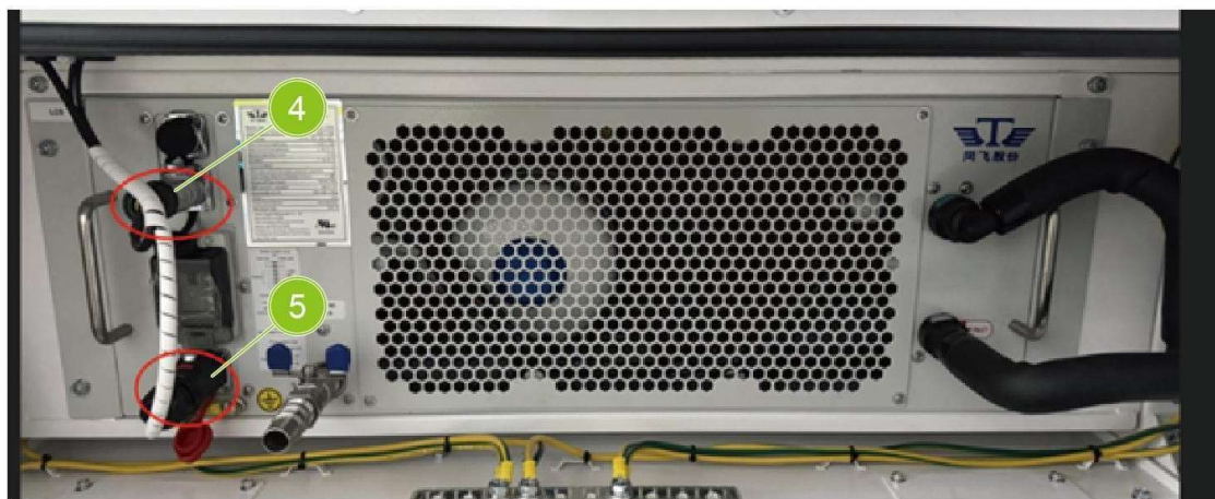
Fig. 9-12 Desconecte los cables de comunicación
