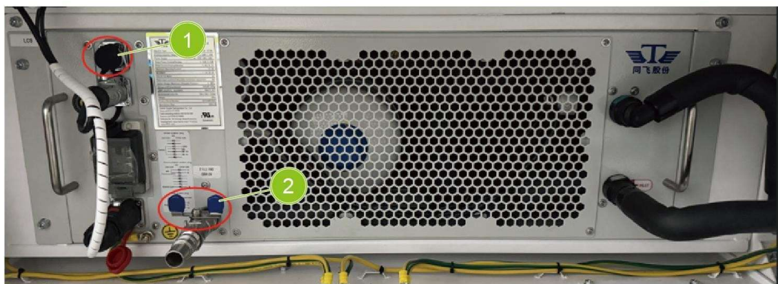
Fig. 9-16 Conecte el conector rápido y cierre la válvula de drenaje
