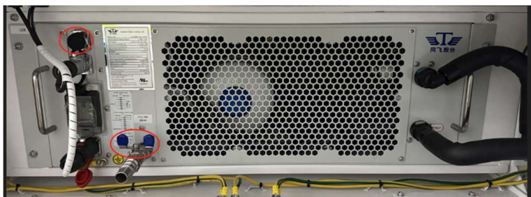
Figura Anexo 6- 17 Cableado de la pantalla de la unidad de refrigeración líquida y posición de la válvula de drenaje
