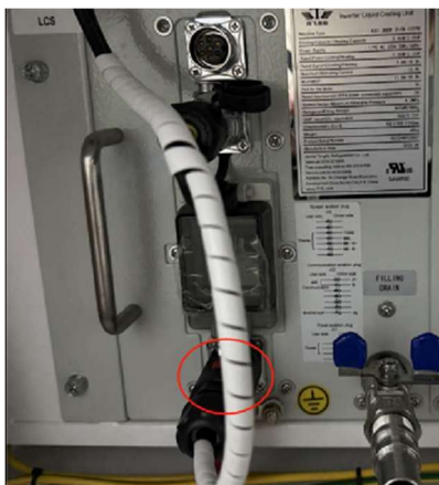
Figura Anexo 6-19 Posición del enchufe de alimentación en la unidad de refrigeración líquida
