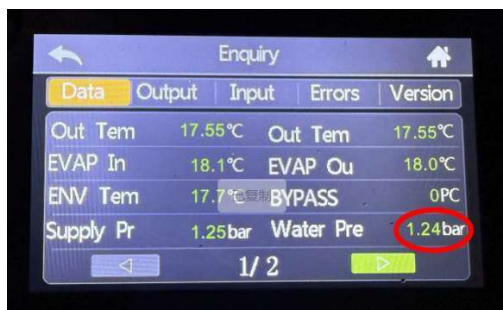
Figura Anexo 6- 21 Pantalla de visualización de la presión del agua de retorno
