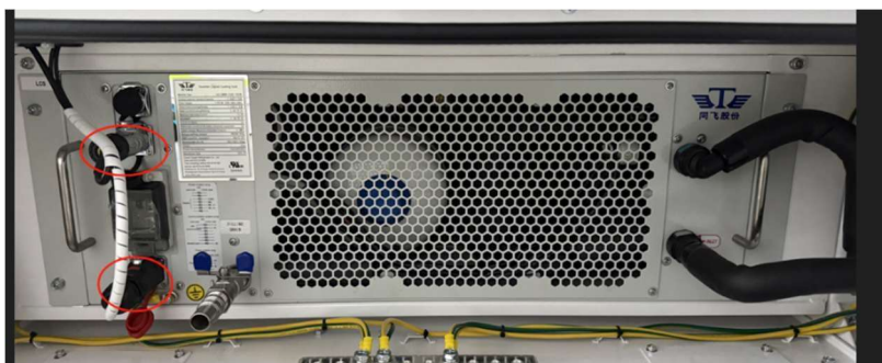
Figura Anexo 6- 13 Interfaces de comunicación y alimentación eléctrica
