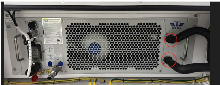
Figura Anexo 6- 14 Retire las tuberías de entrada y salida de la unidad de refrigeración líquida
