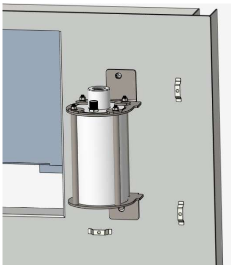
Figura Anexo 6-35Local de instalação do dispositivo de extinção de incêndios
