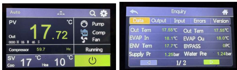
Figura Anexo 6-27 Observe a pressão de injeção do líquido
