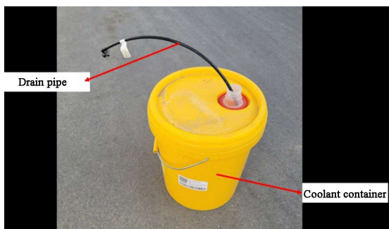
Figura Anexo 6-12 Recipiente de líquido refrigerante
