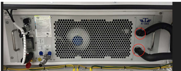
Figura Anexo 6-14 Remova os tubos de entrada e saída da unidade de refrigeração líquida
