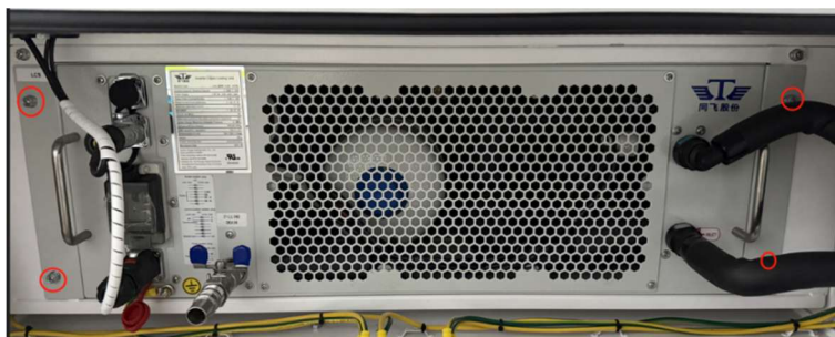
Figura Anexo 6-15 Posição dos parafusos de fixação da unidade de refrigeração líquida
