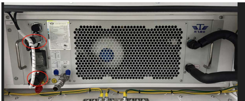
Figura Anexo 6-13 Interfaces de comunicação e alimentação
