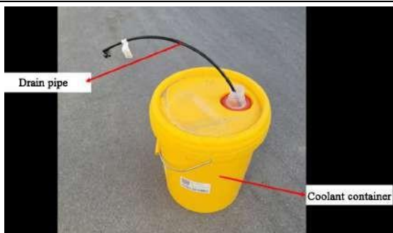
Figura Anexo 6-11 Depósito de refrigerante
