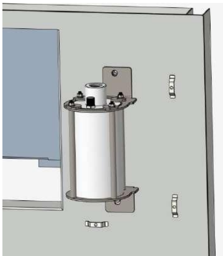
Figura Anexo 6- 34 Ubicación de instalación del dispositivo extintor
