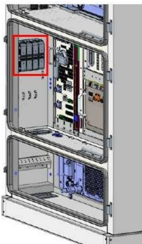
Figura Anexo 6- 41 Terminal de entrada de 400 V
