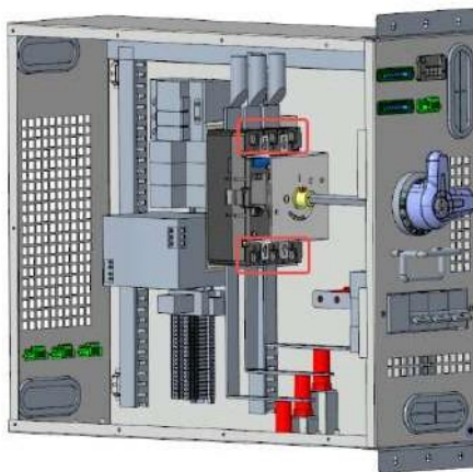
Figura Anexo 6- 44 Retire la barra colectora de cobre y el cable conectados al disyuntor.
