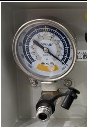
Figura Anexo 6- 22 Pressão da bomba de vácuo
