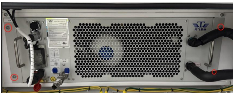
Figura Anexo 6-14 Posição dos parafusos de fixação da unidade de resfriamento líquido
