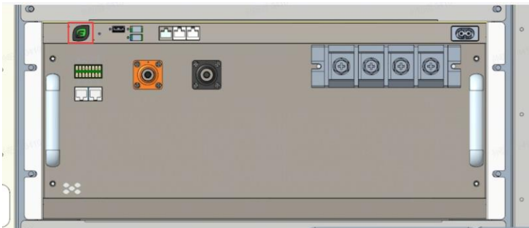
Figura 6-4 Diagrama do painel do PCS
