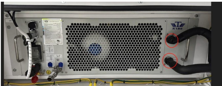
Figura Anexo 6-13 Remova os tubos de entrada e saída da unidade de resfriamento líquido
