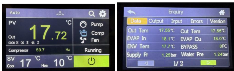
Figura Anexo 6- 26 Observe a pressão de injeção do líquido
