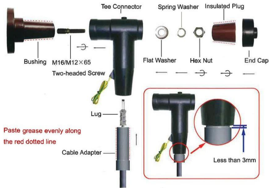
Figura 3-24 Instalación del conector en T
