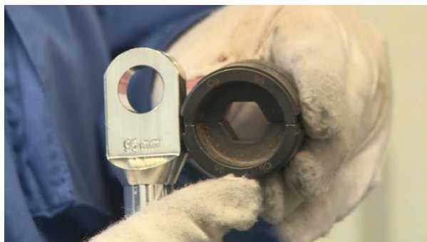
Figura 3-21 Terminais correspondentes à matriz padrão
