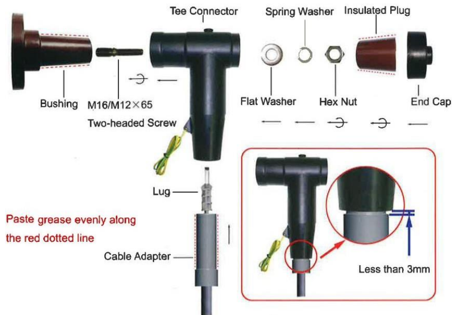
Figura 3-24 Instalação do conector em T
