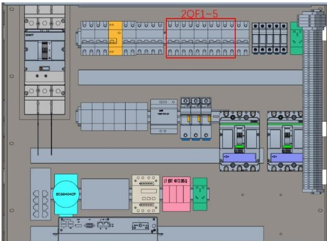
Figura 4- 2 Cierre el microinterruptor 2QF1-2QF5
