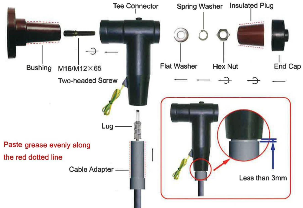
Figura 3-17 Instalación del conector en T
