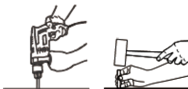
Figura 3-8 Taladrar e instalar el tubo de expansión
