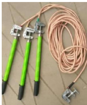
Figura 6- 2 Cabo de aterramento
