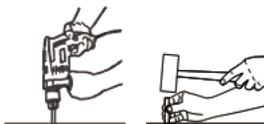
Figura 3-8 Perfure e instale o tubo de expansão
