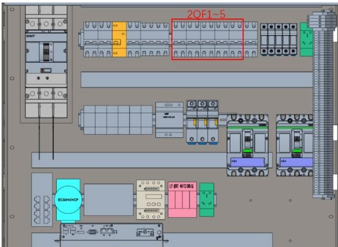
Figura 4- 2 Feche o microdisjuntor 2QF1-2QF5
