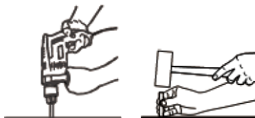
Figura 4-8 Taladrar e instalar el tubo de expansión
