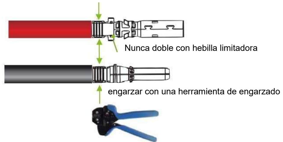
Fig. 4-12 Cables de alimentación prensados
