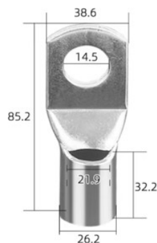
Figura 5-2 Terminal de puesta a tierra (Unidad: mm)
